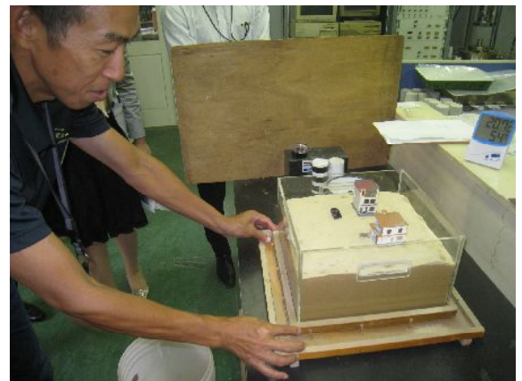
液状化のメカニズムを模型で再現する 使用している砂は「豊浦砂」
