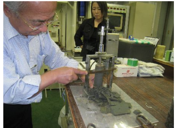
テストピースを見事な円筒形に仕上げる副島取締役 シルトは練れば練るほど柔らかくなる
