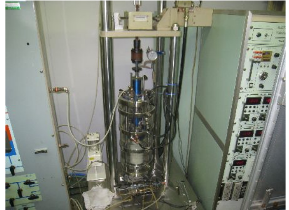
中空ねじりせん断試験装置 いろいろな地震波を入力し载荷できる
