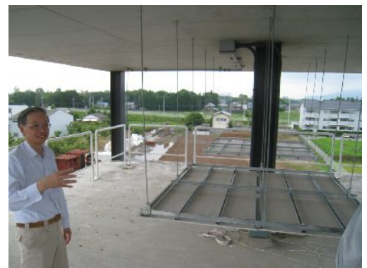
実大振動試験装置で耐震クリップ工法の威力を確認
