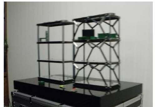
起震台上に載せた建物模型 制震装置のない模型は、揺らすと中の家具が模型の外へ落下してしまった
