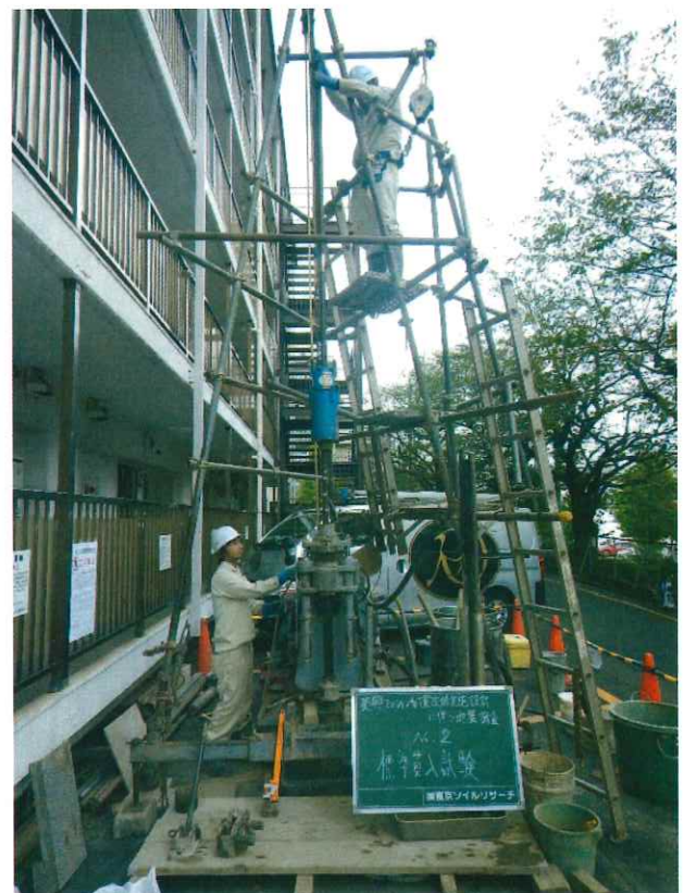
写真4 標準貫入試験実施例
